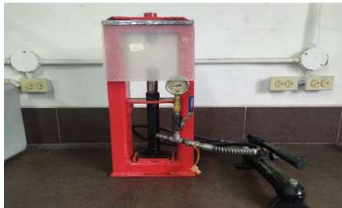
Fig. 1. Equipo para determinación de I_s (50). Fuente: propia.
