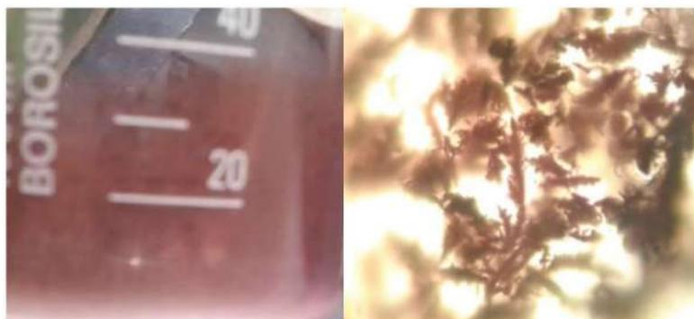
**Fig. 4.** (a) fotografía de películas de cobre sobre cristal como sustrato (b) fotografía con aumento de 100 X en microscopía de inmersión de aceite, se pueden observar estructuras depositadas sobre el cristal.
