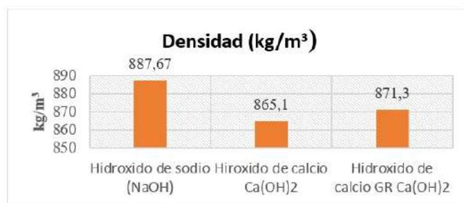
Fig. 2. Densidad del biodiesel obtenido con diferentes catalizadores.
