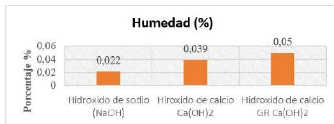
Fig. 4. Humedad del biodiesel obtenido con diferentes catalizadores.
