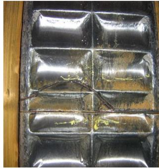
Fig. 4. Típica Rotura de Segmentos, en la cola.
