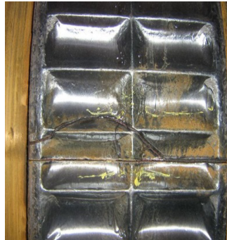
Fig. 4. Típica Rotura de Segmentos, en la cola.
