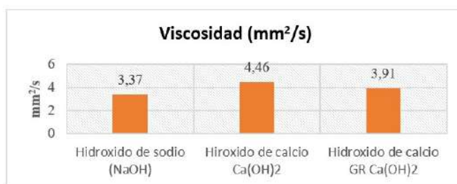
Fig. 3. Viscosidad cinemática del biodiesel obtenido con diferentes catalizadores.
