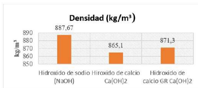
Fig. 2. Densidad del biodiesel obtenido con diferentes catalizadores.
