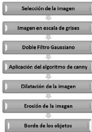
**Fig. 1.** Diagrama de descripción del diseño.
